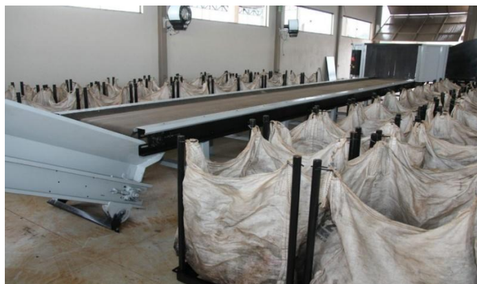
Figura 102 – 40 carros de movimentação de big bag e uma esteira de triagem
