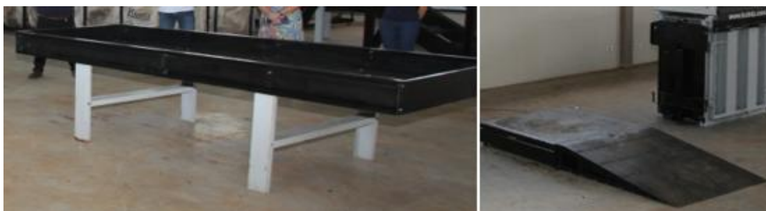
Figura 106 – Mesa de triagem e balança elétrica com rampa e display
