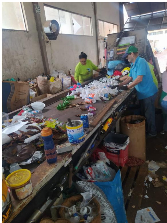
Figura 72 – Esteira de triagem
