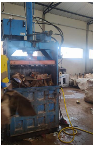
Figura 74 – Prensa vertical de resíduos recicláveis
