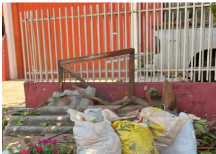
Figura 86 – Destinação inadequada de RCC em vias públicas
